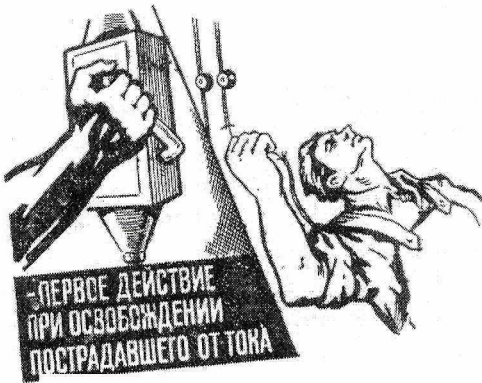
Рис. 1. Освобождение пострадавшего от действия электрического тока путем отключения электроустановки
